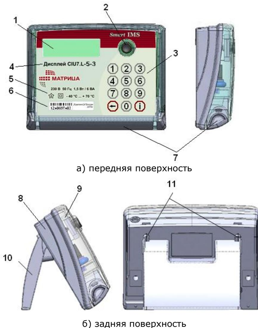
1 – жидкокристаллический индикатор; 2 – функциональная кнопка; 3 – клавиатура (опционально, в зависимости от модификации дисплея); 4 – обозначение типа дисплея; 5 – технические характеристики; 6 – заводской номер счетчика; 7 – батарейный отсек; 8 – задняя крышка корпуса дисплея; 9 – передняя крышка корпуса; 10 – кронштейн для установки дисплея на стол; 11 – пазы для закрепления дисплея на стене;
