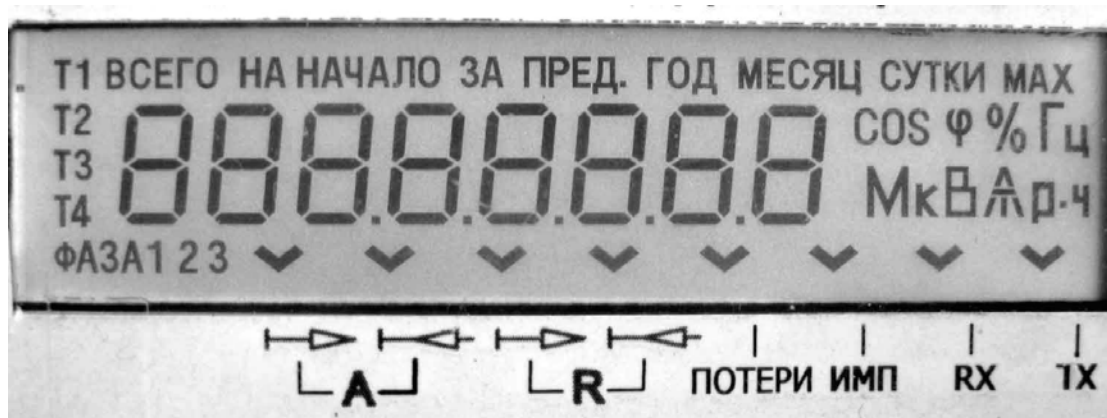
Рисунок 5 – Внешний вид ЖКИ с включенными элементами индикации
