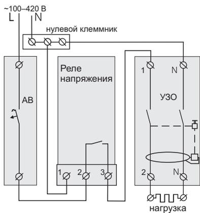
Схема 2. Подключение автоматического выключателя и УЗО
